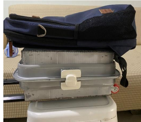
Gambar Uji tumpuk kiri \pm 2,5 kg, kanan \pm 3 kg
